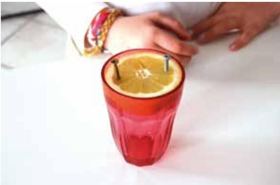
**7** Installe la vis en zinc d'un côté du citron et la vis en cuivre de l'autre.
