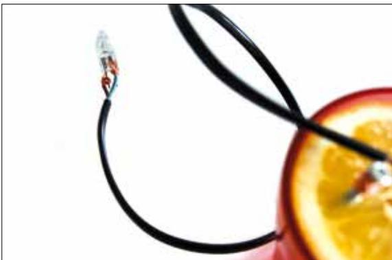
**7** Branche les deux fils de l'autre côté du câble sur chaque polarité de la diode.
