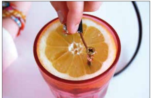
**8** Entoure chaque vis avec l'un des fils dénudés du même côté du câble.
